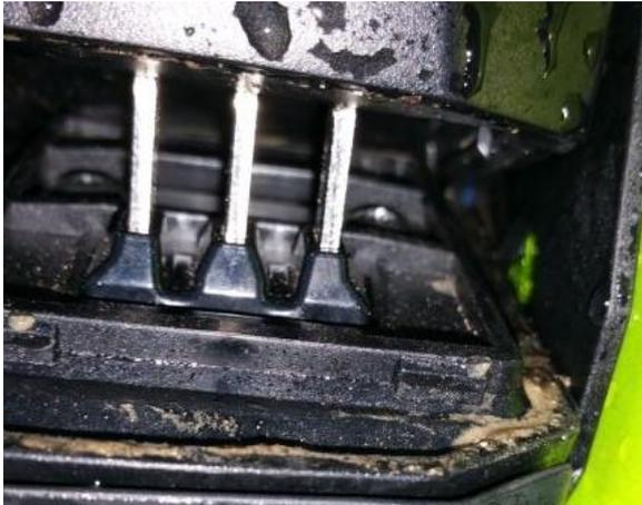
Wie man sieht wurde der Schmutz nicht komplett entfernt. Eine Erklärung könnte sein das der Akku leicht in der Halterung wackelt. Durch das rütteln beim Fahren und die unterschiedlichen Spaltmaße konnte der Schmutz besser eindringen.
