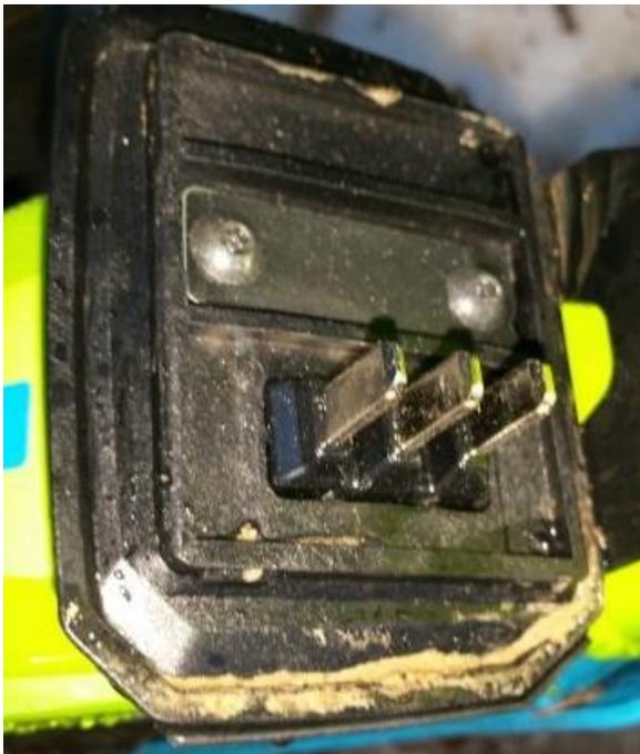
Detailaufnahme der Akkuhalterung. Es ist immer noch entsprechend Schmutz enthalten. Dieser muss mit einem leicht feuchten Tuch entfernt werden. Die Kontakte reinige ich nur mit einem trockenen Tuch. Es besteht sonst die Gefahr dass die Kontakte korrodieren.
